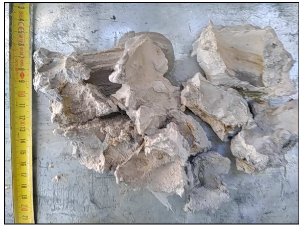
Sol : argile limoneuse blanchâtre à cailloutis tarière T1 : échantillon prélevé entre -2,0 et -2,7 m
